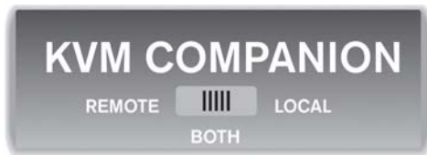
Figure 2.4 : Interrupteur de confidentialité à 3 positions
